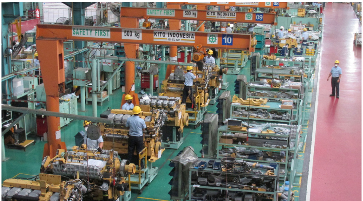
ライフサイクル設計が標準化されている建設機械。(写真上) 建機のリマン工場（再製造 (Remanufacturing) のことは「リマン」と呼ばれている。）(写真下) 画像出典：コマツ
